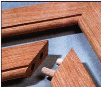
Угловое клеевое соединение «на ус» деталей рамы усилено двумя деревянными шкантами. Собранный раму на время сушки клея стягивают ремнями.
