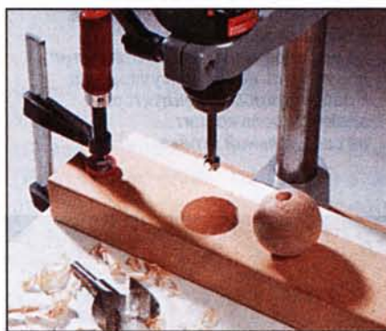
Чтобы просверлить отверстие под шкант в деревянном шарике, делают простое приспособление. В технологическом бруске сверлят отверстие, диаметр которого несколько меньше диаметра шарика. Выставив отверстие в бруске относительно закреплённого в дрели сверла, прижимают брусок к основанию сверлильной стойки. Положив шарик в отверстие приспособления, сверлят отверстие под шкант.
