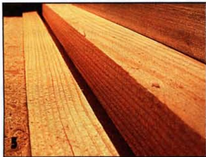
40-зубый диск для поперечного пиления даже при продольном раскрое показал себя очень неплохо, но до идеала всё-таки не дотянул.
