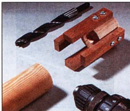
Точно просверлить отверстие в торце цилиндрической заготовки можно с помощью самодельного кондуктора, изготовленного из отрезка от этой заготовки и привинченных к нему четырёх упоров (отрезки бруска прямоугольного сечения).
