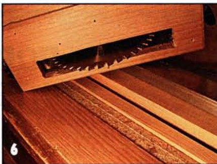
Диск (с отрицательным углом наклона зубьев) по алюминию и ДСП оказался лидером в устроенных мною соревнованиях по продольному пилению мебельных щитов.
