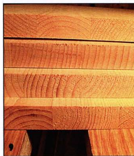
Диск по алюминию и ДСП с поперечным резанием справился значительно хуже диска специализированного.
